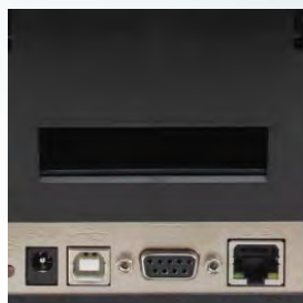
USB 2.0, Ethernet 10/100 ja RS-232 Serial (DB-9)
